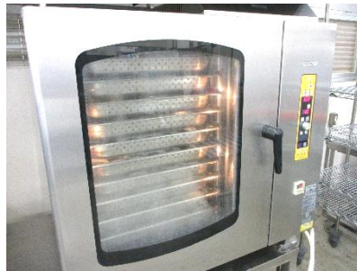
給食室のオーブンはスチーム 機能がついているので、 蒸し物もできます。
